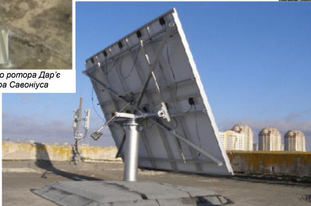
Сонячна енергетична установка з двокоординатною поворотною платформою
