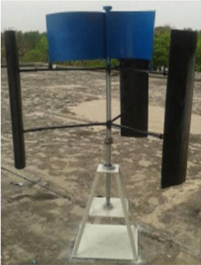
Комбінування трилопатевого ротора Дар'є та трилопатевого ротора Савоніуса
